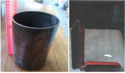
Балони для вогнегасників вуглекислотних об'ємом 2...8 л, технологія базується на глибокій витяжці з листа та закатуванні горловини при нагріві ТВЧ, що в два рази економічніша за виготовлення із товстостінної труби. Технологія перевірена при виготовленні пробної партії
