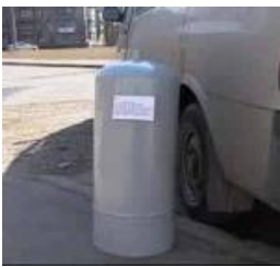
Балони для автомобілів як для пропан-бутану 50 атм так і метану 260 атм, глибока витяжка без зварювальних швів. Виготовлені пробні зразки.
