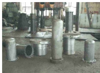
Балони для автомобілів як для пропан-бутану 50 атм так і метану 260 атм, глибока витяжка без зварювальних швів. Виготовлені пробні зразки.
