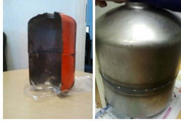
Балони для порошкових вогнегасників, витяжка з тонколистового металу. Проведено експериментальне випробування
