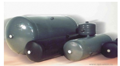
Резервуари об'ємом 12...500л 8..12 атм для залізничі, метрополітену, зварювальні із листового металу. Серійне виробництво.
